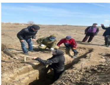
4,5,6-суреттер – Тәжірибелік алаңның топырақ жыныстарының геологиялық құрылымын анықтау үшін шурф орнату жұмыстары мен вертикальді қимасының геологиялық кескіні
